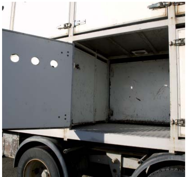
Kaksikerrosauton sivusta avattavat karsinat helpottavat ja nopeuttavat purkua teurastamolla.
