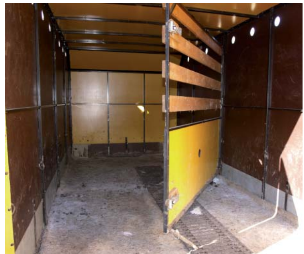
Suuremmissa kärryissä tilan osastointi on helppo toteuttaa käännettävillä väliseinillä.
