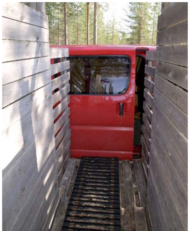
Kujien liukumaton alusta ehkäisee vaurioita lastaus-tilanteissa.
