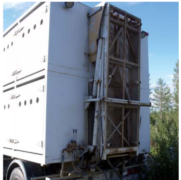
Kaksikerrosauton koottava lastausramppi.
