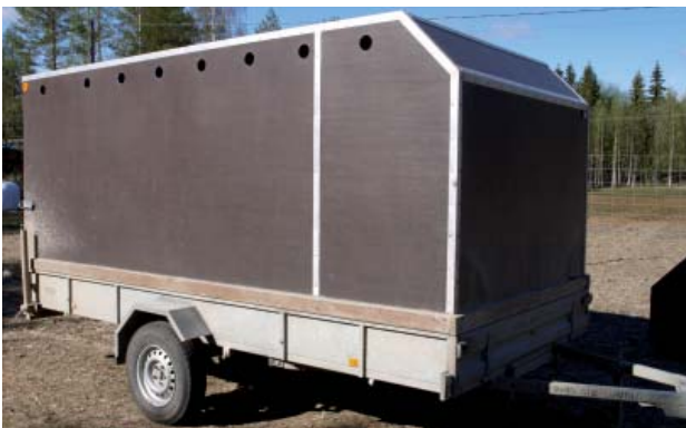
Levyseinäinen kuljetuskärry suojaa poroja viimalta ja kylmyydeltä.
