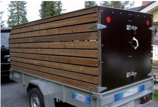
Lautarakenteisessa kuljetuskärryssä rakojen tulee olla riittävän pienet, etteivät porojen jalat tai sarvet voi tarttua niihin kiinni.
