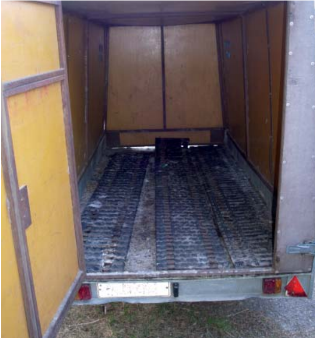
Kuljetusvälineen pohjan liukkautta voidaan vähentää esim. telamatoilla.
