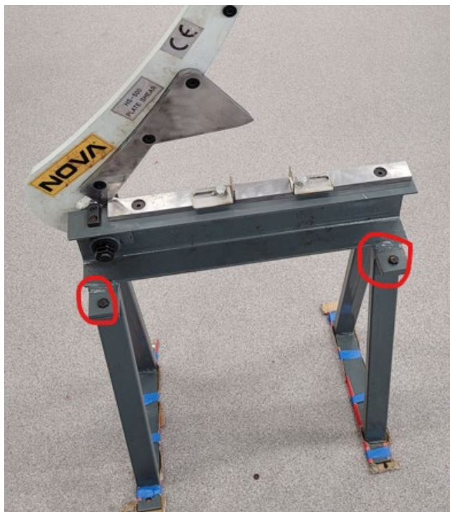
Kuva 1. Koparaleikkurin jalkojen kiinnityspultit
