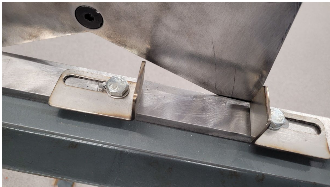
Kuva 7. Terän ja vastimen välyksen tarkistus
