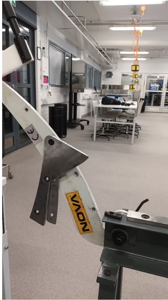
Kuva 5. Leikkuuvarsi käännettynä taakse, alimmat pultit irrotettuina
