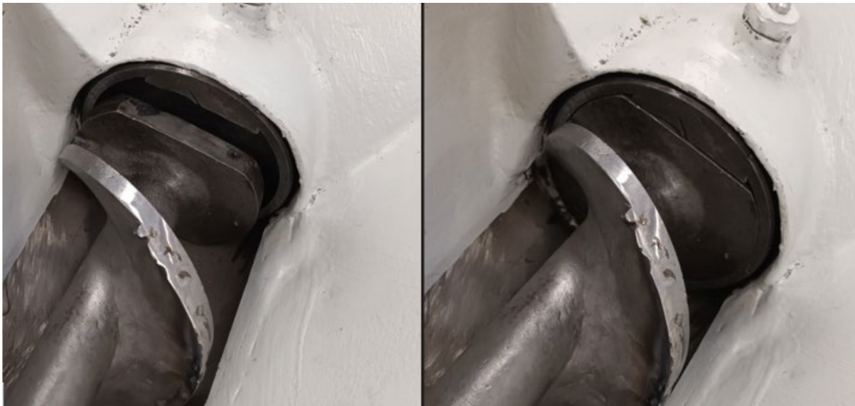
Kuva 6. Syöttöruuvien sovitus (kuvassa oikealla oikein)
