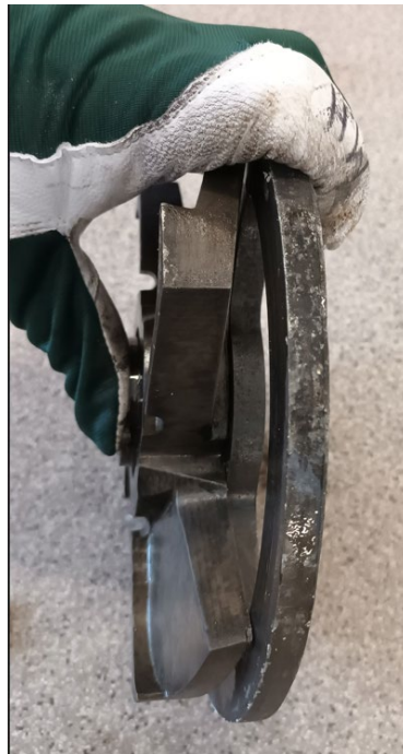
Kuva 9. Terien aseointi reikälevyihin
