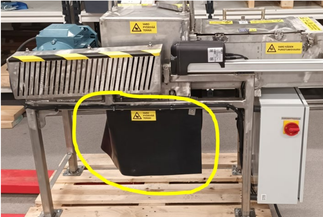
Kuva 2. Päänkäsittelylaitteen roiskesuoja (ympyröity osa)
