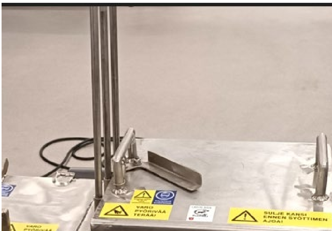
Kuva 6. Syöttökourun turvaportti ja sen lukituskahva
