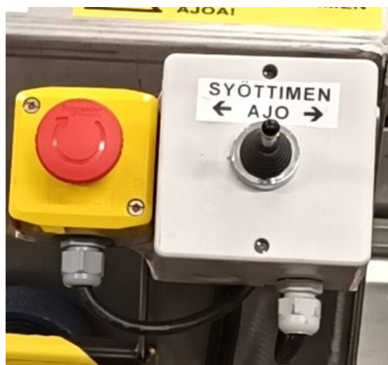
Kuva 5. Hätäkatkaisija (vas.) ja syöttimen ohjaussauva (oik.)
